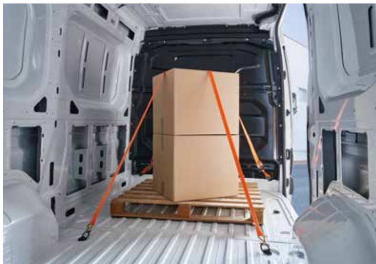
8 (L2) és 10 (L3) darab rakományrögzítő pont.
