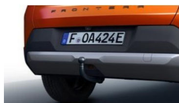
Szerszám nélkül leszerelhető vonóhorog (5 személyes kivitelhez, 17768 gyártástól)
