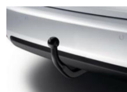
Szerszám nélkül leszerelhető vonóhorog 13 pólusú csatlakozóval
